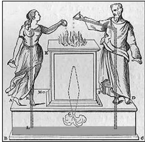
Figura 4: Libaciones en un altar, producidas por el fuego. Fuente: Herón, The Pneumatics [1].
